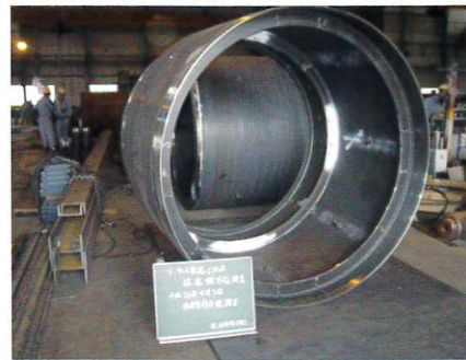
掘進機の外殻製作
