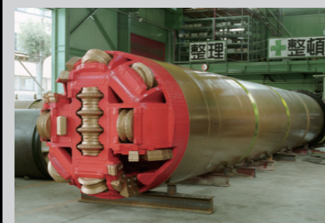
■シールド機全景
