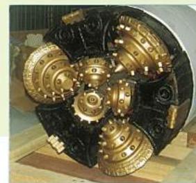
軟岩推進到達直後 土質: 泥岩(青灰色) 一軸圧縮強度: 20~30N/mm 2 管径: φ200mm
