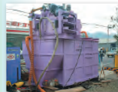
泥水処理装置
